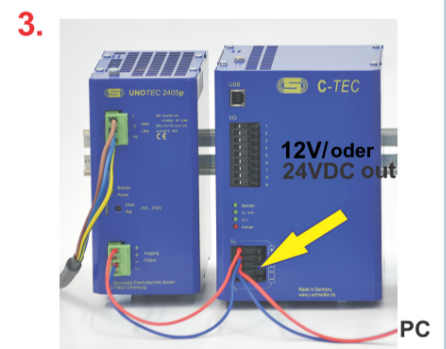
Anschluss des PCs an den 12V/24VDC Ausgang der USV
